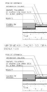
IMPERMEABILIZAÇÃO SOBRADA ESCALA 1:2,5
